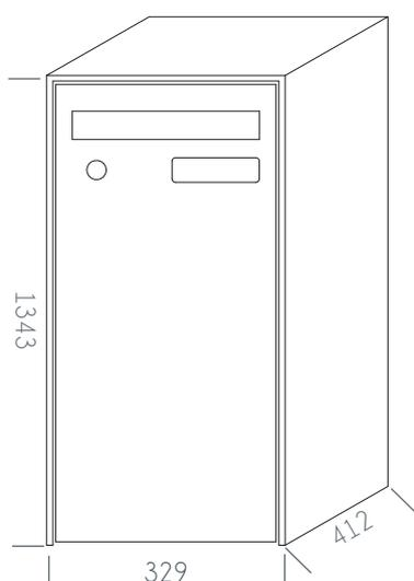
Corps en acier revêtu avec 2 compartiments permettant de recevoir le courrier en partie haute et les colis volumineux en partie basse. Porte en acier revêtu bi-métal, équipée d'une serrure agréée La Poste et d'un volet doté de butées anti-bruit. Système anti-vandalisme 8 points d'ancrage.
